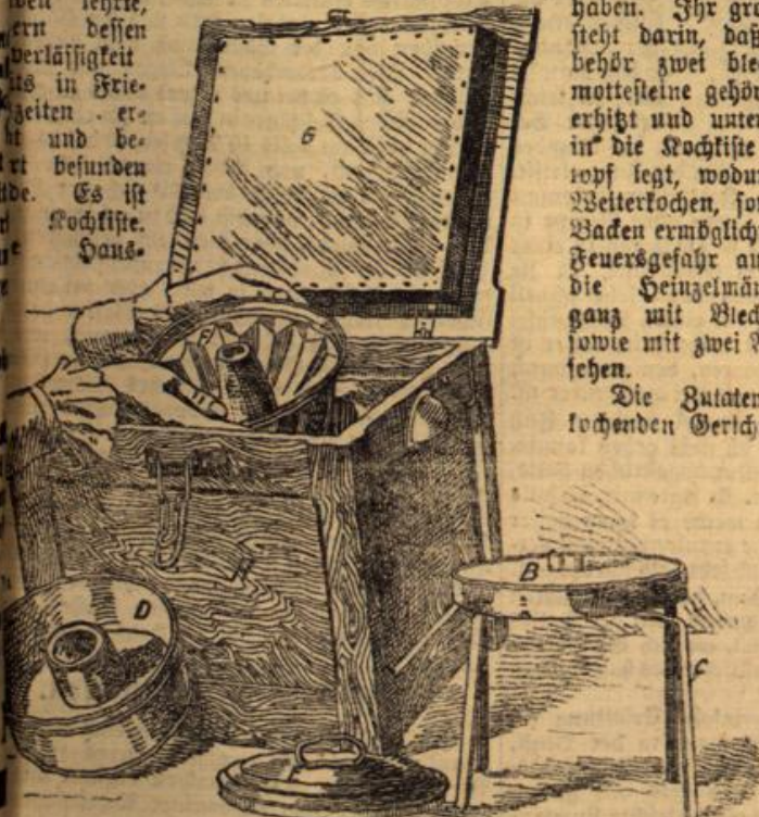
Abbildung 1. Einzelmannchen-Apparat mit einer Kochkiste. A: Einzelmannchen, B: Schmortopfe (Wärmespeicher), C: Leber, D: Braten, E: Fuddingform und Deckel, F: Backform, G: Schließdeckel, isoliert.
