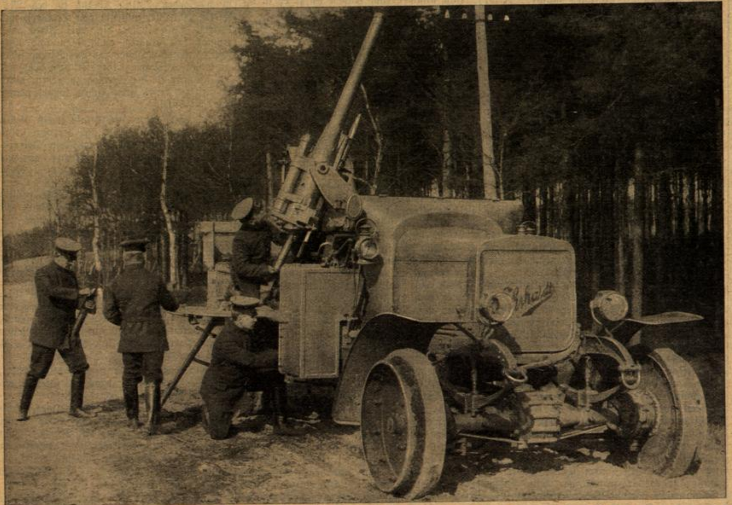
Der Kampf in den Lüften: Erhardt'sche 7,5 Zentimeter Ballonabwehrkanone auf einem Kraftwagen. Mit der immer rascher vorwärtsschreitenden Vervollkommnung unserer Luftfahrzeuge hält gleichen Schritt die Verbesserung der Waffen zur Vernichtung derselben. Unser Bild zeigt eine 7,5 cm Ballonabwehrkanone auf einem Kraftwagen, mit welcher sehr gute Resultate bei Beschießung von Luftfahrzeugen erzielt wurden.
