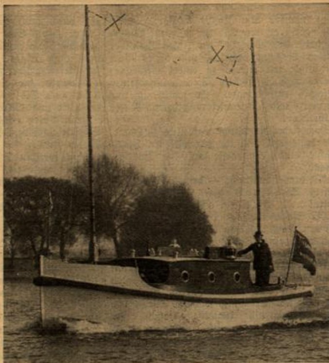
Ein Motorrettungsboot mit drahtloser Telegraphie.
